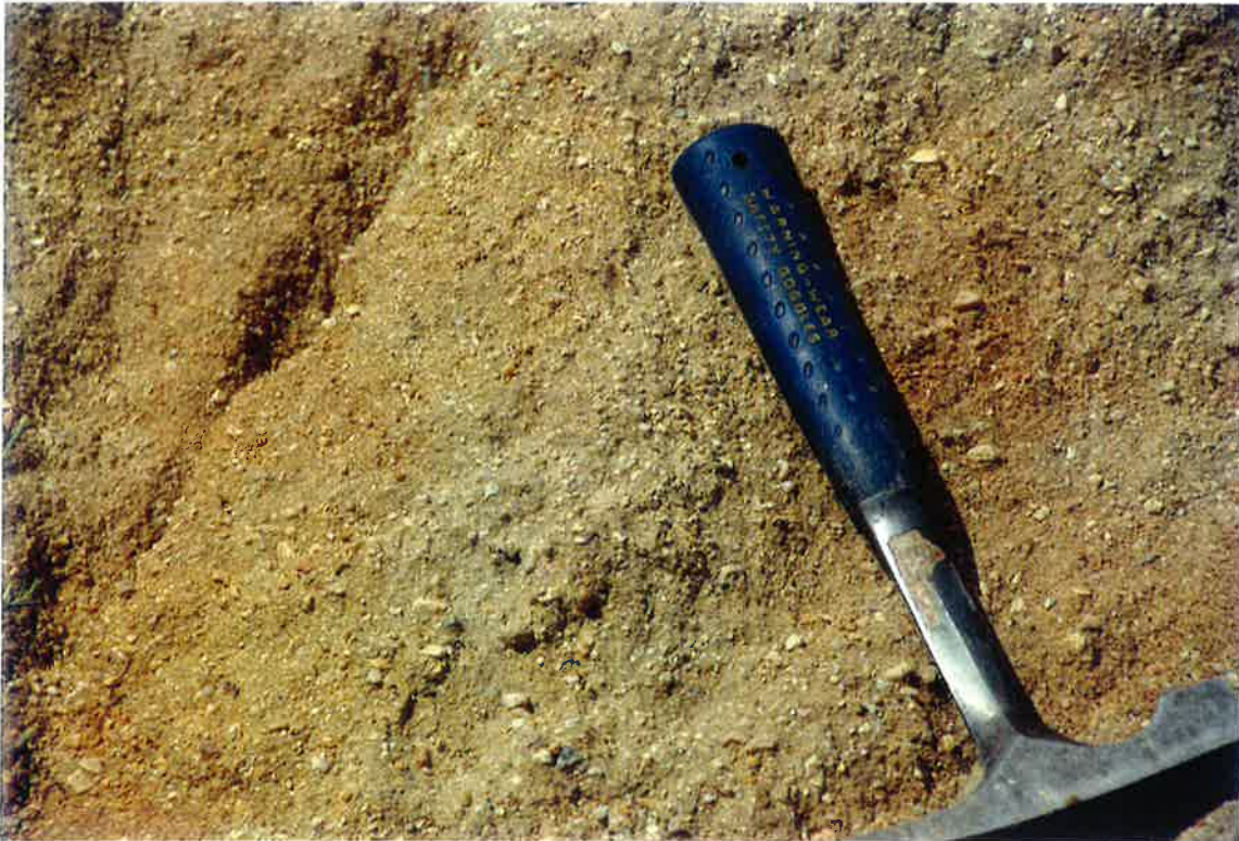
FOTO 9003.- Columna estratigráfica de Villamarcial. Facies de Pedraja de Portillo. Conglomerados con estratificación cruzada (facies Gt) formados por clastos de cuarzo, cuarcita y feldespato con matriz arenosa. El centil es de 2 cm.
